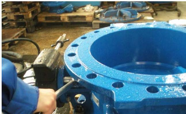
*Montaje del reductor – paso 5*
