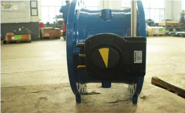
*Compruebe la posición del indicador de posición – paso 4*
