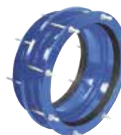
Serie 259 Unión reducida para tuberías de FB, acero, o fundición dúctil Acero DN 350-2000 PN 8 hasta 25
