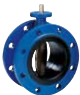
Serie 75/20 Válvula de mariposa Concéntrica con junta vulcanizada al cuerpo Tipo Doble brida corta DN 50-2000 PN 10/16 Fundición dúctil
