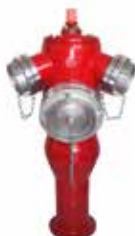
Serie 78 Hidrante de columna seca Tipo C Profundidad enterrada 1000, 1250, 1500 mm DN 80-100 PN 16 Fundición dúctil Racores Storz
