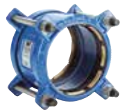
Serie 621/10 Unión Supa Plus™ Anti-tracción para tuberías de PE y PVC Fundición dúctil DN 32-300 PN 16
