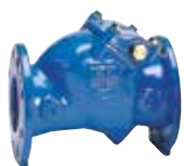
Serie 41/61 Válvula de retención de clapeta Asiento elástico DN 50-300 PN 10/16 Fundición dúctil
