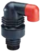
Serie 701/40 Ventosa trifuncional DN 20, 25 y 50 Rosca BSP de 3/4", 1" o 2" PN 16 Nylon reforzado
