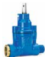
Serie 03/85 Válvula de registro con acoplamiento para tuberías de PE / rosca macho DN 25-32 PN 16 Fundición dúctil
