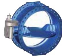
Serie 756/102 Válvula de mariposa Doble excéntrica Asiento de acero inoxidable Reductor motorizable DN 200-2800 PN 10/16 Fundición dúctil
