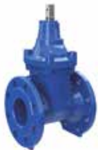
Serie 02/20 Válvula de compuerta embridada según BS DN 50-400 PN 10/16 Fundición dúctil
