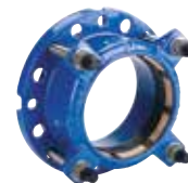
Serie 623/10 Brida Supa Plus™ Anti-tracción para tuberías de PE y PVC Fundición dúctil DN 40-300 PN 10/16
