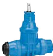
Serie 16/29 Válvula de registro con enchufe/ rosca macho DN 25-50 PN 16 POM (Polioximetileno)
